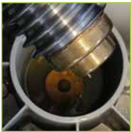
Ölbadgetriebe dauergeschmiert und perfekt gekühlt.
