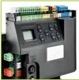
Programmschnittstelle und herausnehmbare Reihenklemmen
