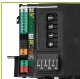
Programmierschnittstelle und herausnehmbare Reihenklemmen
