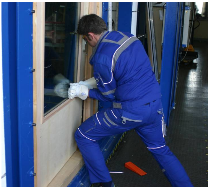
Bild 4 Fenster bei der manuellen Einbruchprüfung im ift Rosenheim
